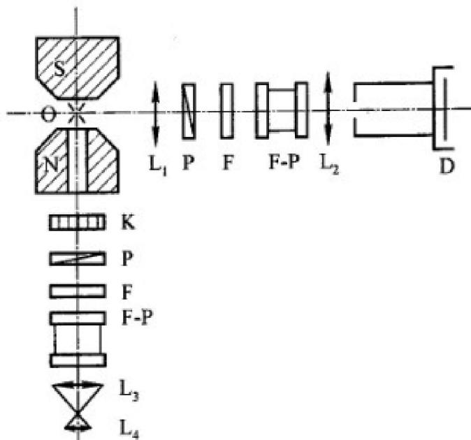
图 2.1.1-4 塞曼效应实验装置图
