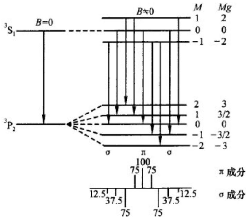
图 2.1.1-1 Hg(546.1 nm) 谱线在磁场中的分裂
