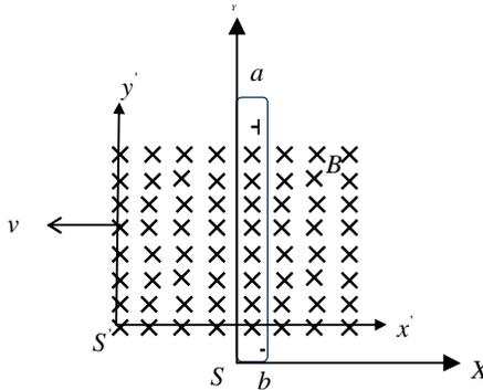
图 6-4 磁力线切割金属导体
